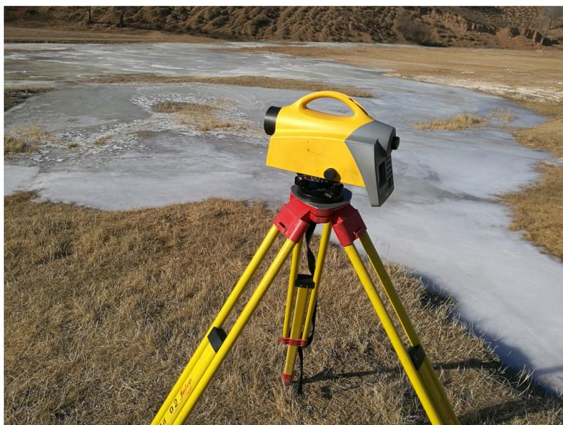
零下 22° 的内蒙控制测量的水准测量
