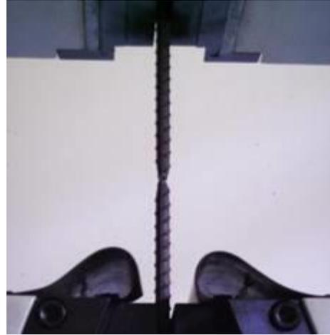
4、试验过程中绘制或打印荷载—变形曲线，由曲线和指针读出或打印出屈服荷载（kN）和极限荷载（kN）；
